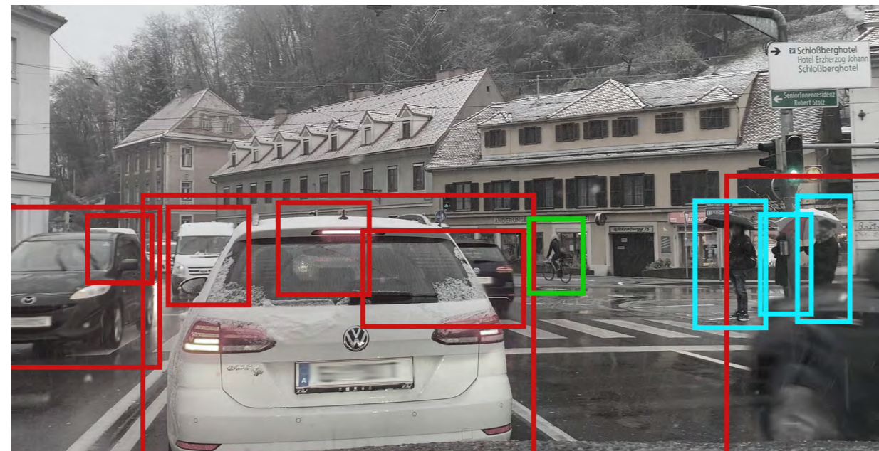
Straßenseitig erhobene Sensordaten werden so umgerechnet, als hätte das vorbeifahrende Fahrzeug die Umgebung registriert (Ego-View). ©ALP.Lab
